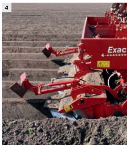
De hoeveelheid in het element (3) wordt via sensoren zeer nauwkeurig gestuurd. Na de afleg van de knollen wordt de rug meteen met de aanaardkap (4) gevormd.
