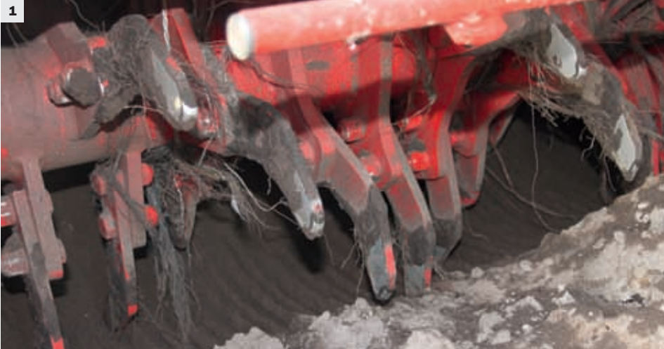
Met de GR 300 wordt de gehele breedte bewerkt (1). De 110 freeshaken zijn spiraalvormig gerangschikt, wat voor een zeer rustige loop zorgt.
